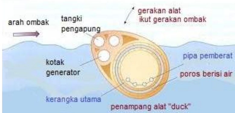
Gambar 5.20 Pembangkit listrik energi ombak—Sistem Salter Duck. (Sumber: people.bath.ac.uk)
