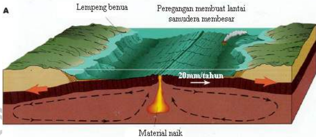
Gambar 4.9 Penampang punggung tengah samudra. Tampak material magma pijar naik ke lantai samudra dan lempeng-lempeng samudra saling menjauh. (Sumber: palaeblog.blogspot.com )
