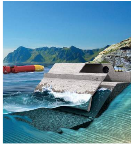
Gambar 5.18 Pembangkit listrik energi ombak. (Sumber: schaeffler.com)
